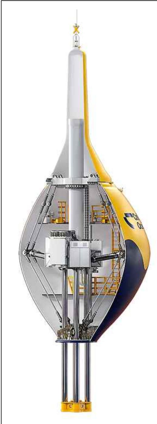
Die Boje an der Meeresoberfläche ist nicht mit einem herkömmlichen Kabel mit dem Anker verbunden, sondern mit einer Komponente für den Ausgleich des Tidenhubs (Tidal Regulator) und einer halbfesten Struktur, einem Flex Rod - ein flexibler Stab - aus Kompositmaterial, der sowohl eine Auf-und-ab- als auch eine Seitwärtsbewegung der Boje erlaubt. Das gegenwärtige Pilotprojekt C4 befindet sich in rund 40 m tiefem Wasser, aber Wassertiefen von bis zu 100 m sind möglich.
