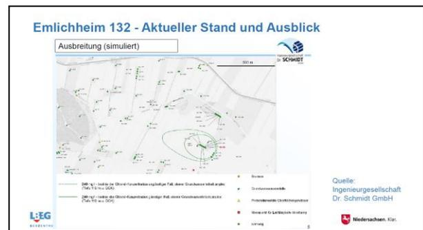
Die Karte stellt die aktuelle Prognose der flächigen Ausbreitung der Schadstoffe dar. Im oberen Bereich der Karte erkennen Sie die Grenze zu den Niederlanden; die Bohrung EMLH 132 liegt gut 500 m südlich der Grenze.
